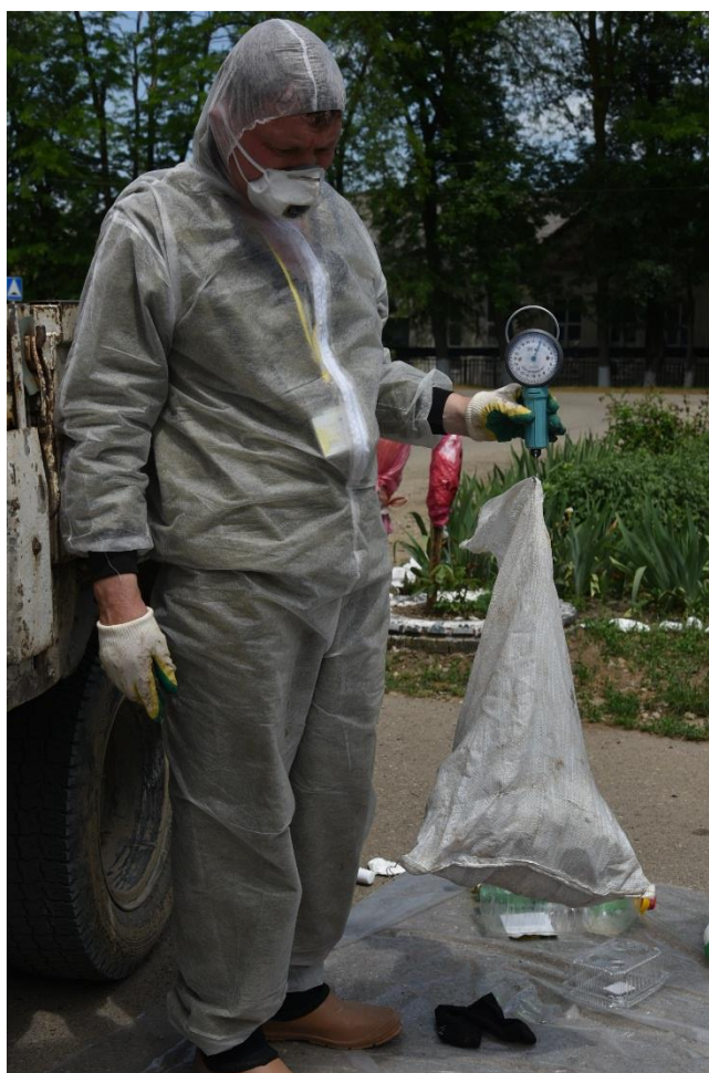
Рис.24. Проведение работ по определению морфологического состава ТКО и КГО на контейнерной площадке: г. Апшеронск, ул. Комарова,48
