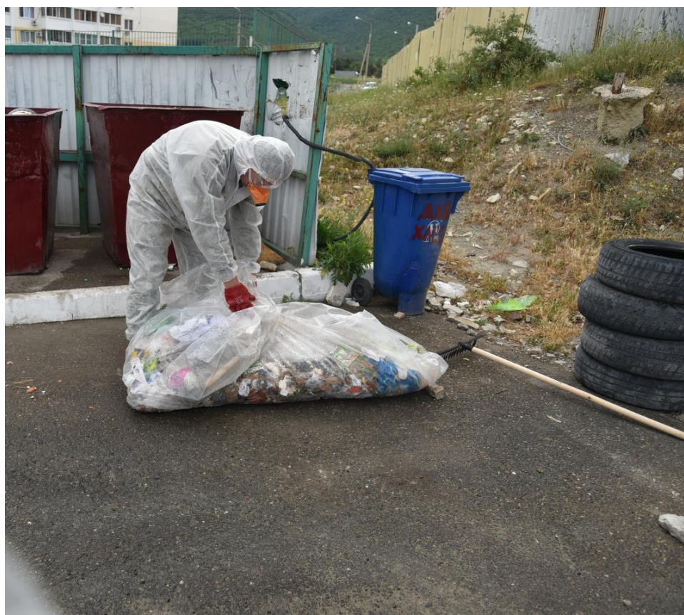
Рис.13. Подготовка и окончание работ по определению морфологического состава ТКО и КГО на контейнерной площадке: г. Геленджик, ул. Маршала Жукова,1
